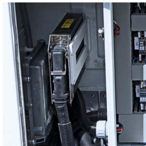
Im Fahrzeug verbauter leistungsstarker SafetyController der Bauart CR7 aus der Reihe *ecomatmobile* von ifm sorgt für Sicherheit beim mobilen Einsatz.
