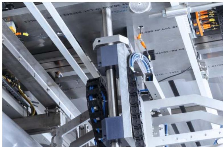
Sämtliche Sensorik ist über Module an das Bussystem AS-Interface (AS-i) angeschlossen.
