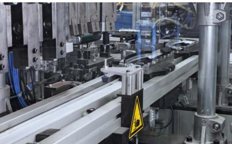
Montageautomat zur Produktion von Staubsaugerdüsen.
