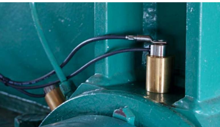
Je zwei versetzt angebrachte Schwingungssensoren überwachen permanent den Zustand der rotierenden Lager.
