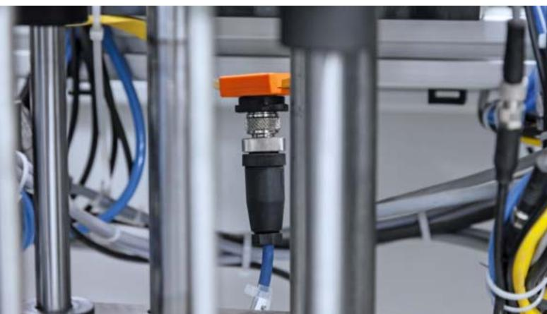
Mit einfacher Durchdringungstechnik ist das AS-i Modul am gelben AS-i Flachkabel anschließbar. Das Kabel kann dabei quer oder längs durch das Modul geführt werden. Die Montage des AS-i Moduls erfolgt ohne Werkzeug – zur Demontage wird lediglich ein Schraubendreher benötigt.
