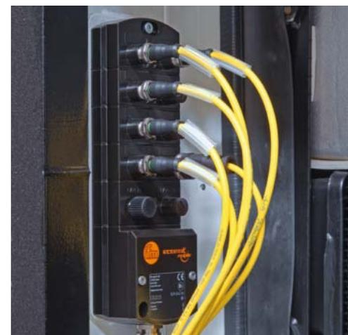
Robustes dezentral verbautes E/A-Modul CR2033 leitet die Signale über CANbus zur Steuerung.
