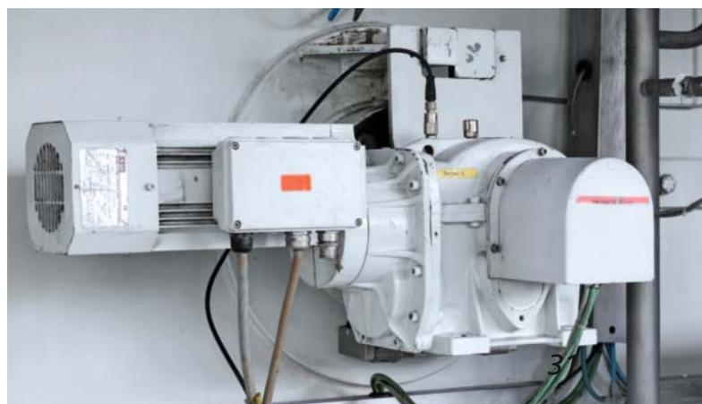
Das System besteht zum einen aus Schwingungssensoren vom Typ VSA001 und zum anderen aus Auswerteeinheiten, Typ VSE100.
