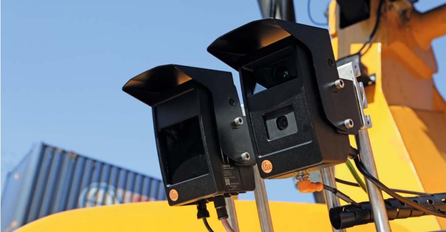
O3M-System: 3D-Kamera (rechts) und Infrarot-Beleuchtungseinheit (links).
