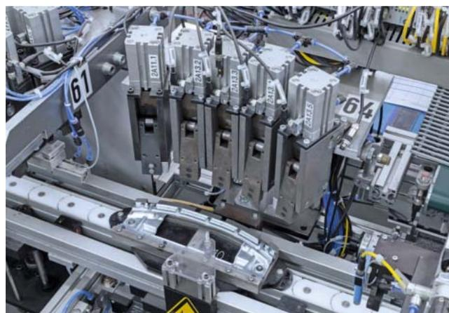
*An mehreren Montagestationen wird aus Einzelteilen vollautomatisch eine Staubsaugerdüse zusammengesetzt.*
