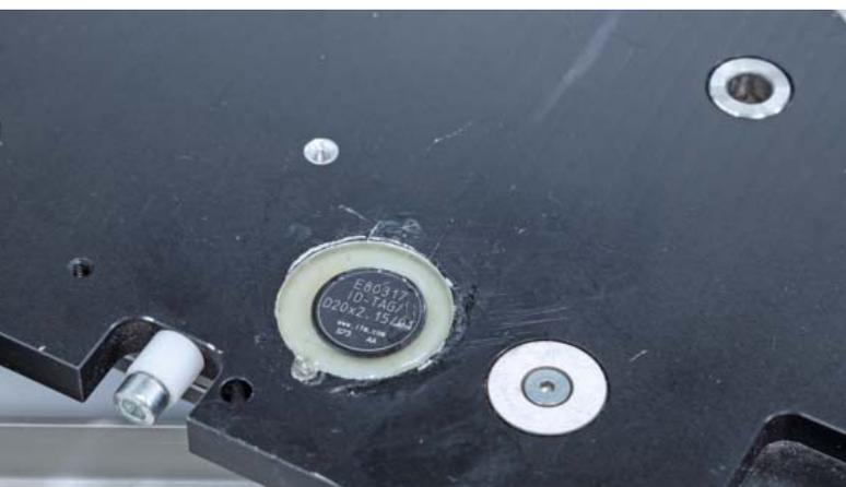
*Unten im Werkstückträger ist der Transponder-Chip eingelassen. Bis zu 224 Bit kann dieser Chip speichern.*
