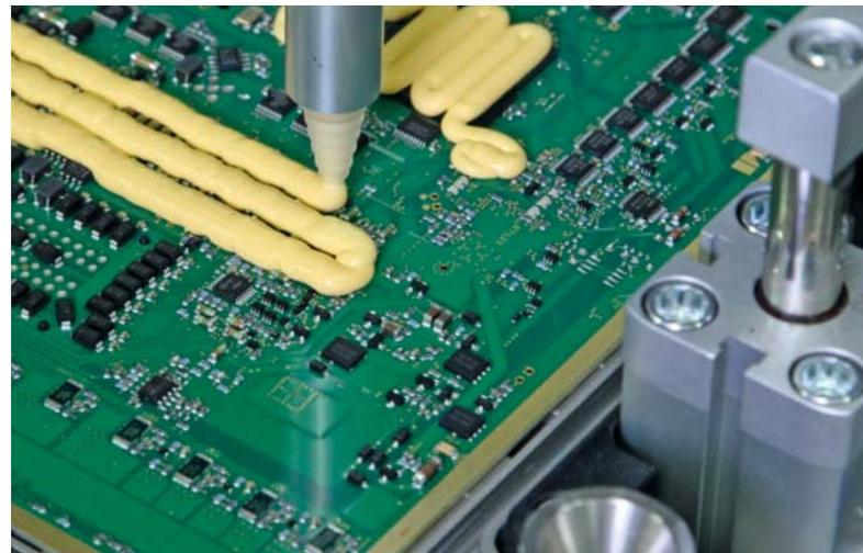
*Auftrag der 2-Komponenten-Wärmeleitpaste auf die Leiterplatte.*
