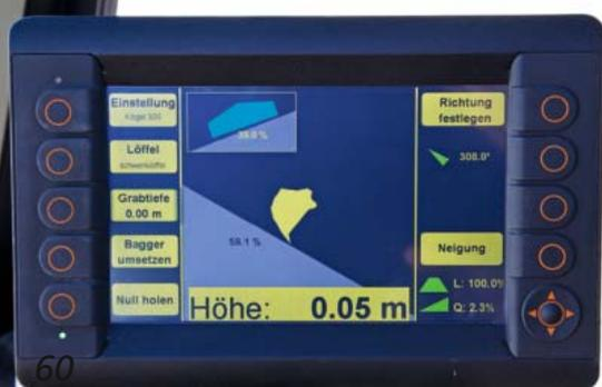
Das ifm-Dialoggerät CR1082 dient zur Anzeige und Dateneingabe, außerdem führt die integrierte SPS die Höhenberechnung durch.
