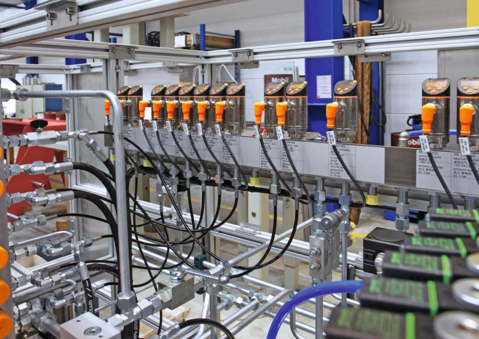
*IO-Link-Sensoren liefern Daten zur optimalen Maschinensteuerung.*
