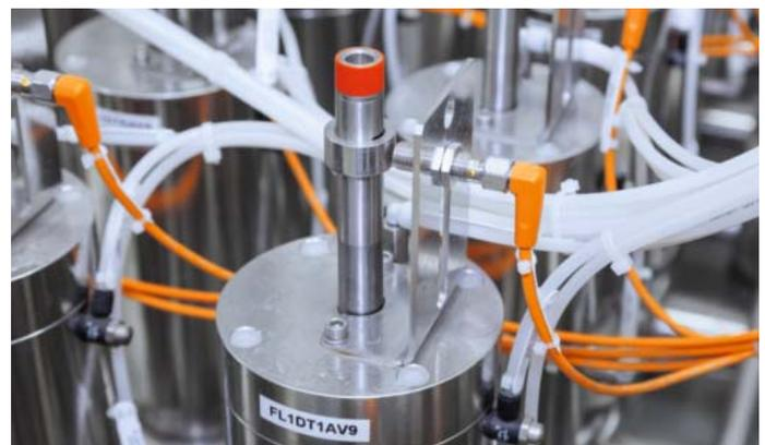
Positionsrückmeldung: Der induktive Sensor IFT203 überwacht die Hubstange und meldet der Steuerung, ob das Ventil auch tatsächlich geöffnet ist.
