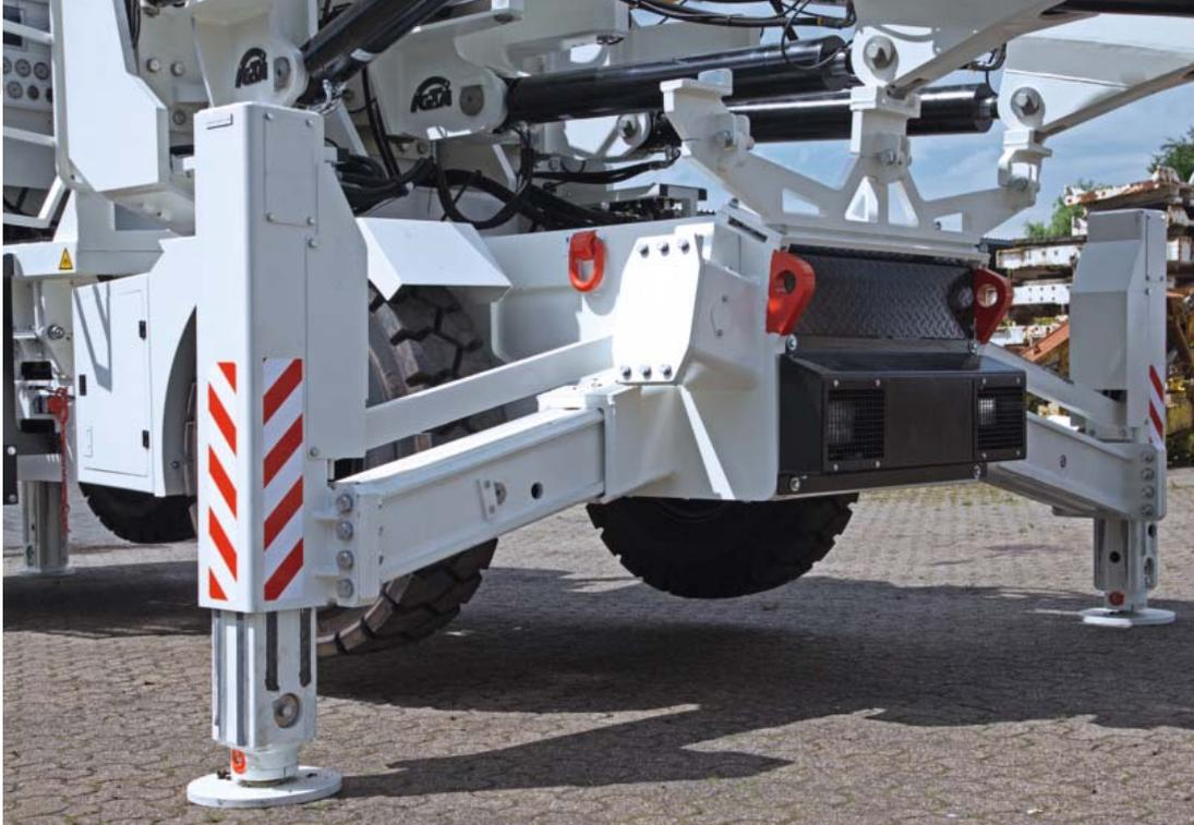
Vordere vertikale Ausfahrzylinder sowie zwei horizontale Teleskope geben dem Unterwagen die erforderliche Standsicherheit.
