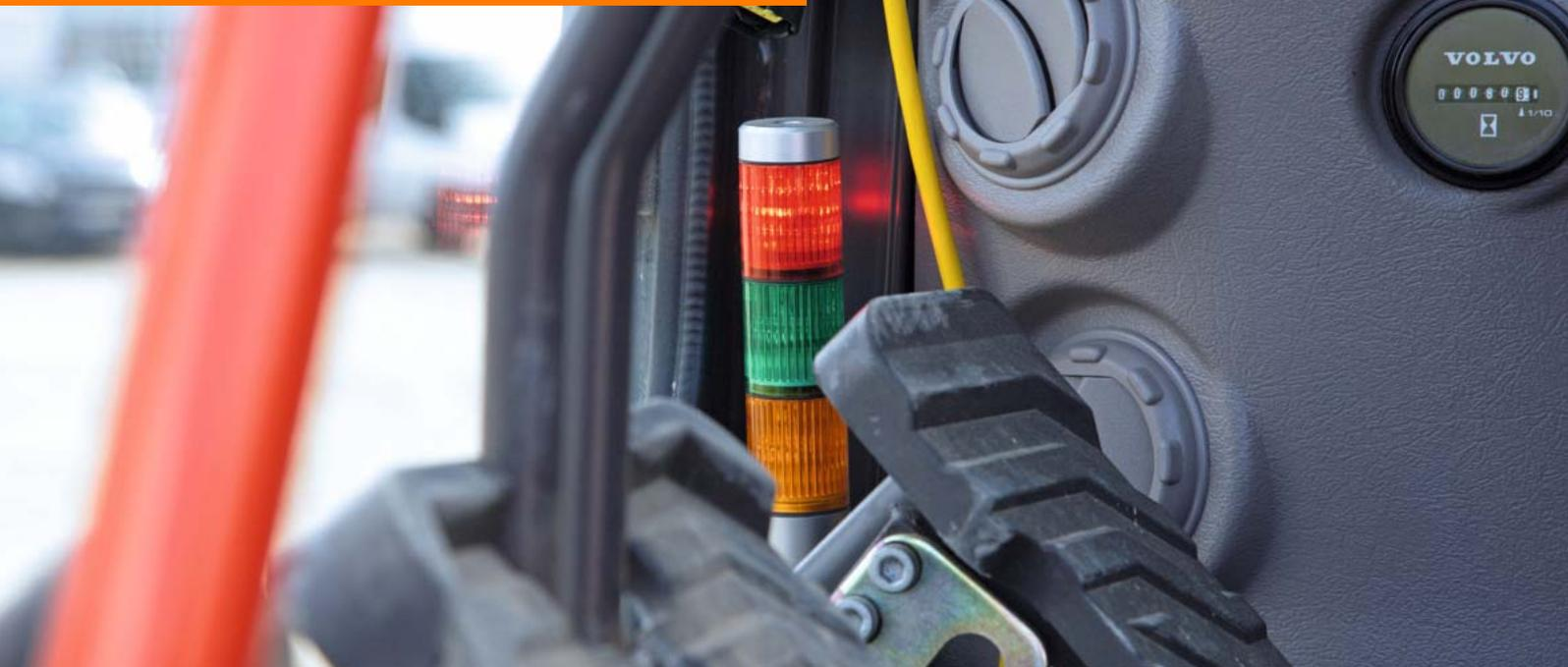
Eine Ampel im Blickfeld des Baggerführers zeigt, ob sich die Schaufel zu hoch oder zu niedrig befindet.
